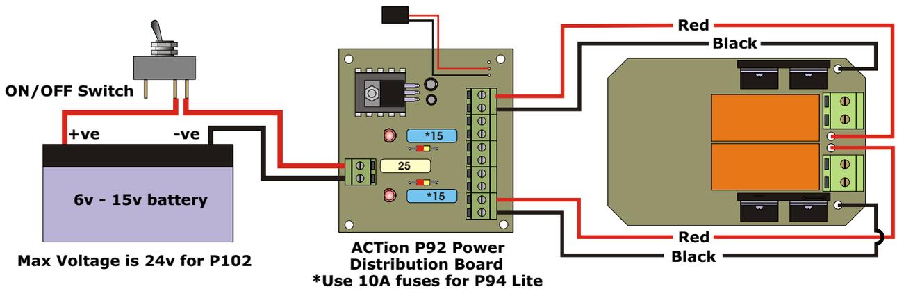
**FIG #5: USING POWER DISTRIBUTION BOARD P92 OR P102**
