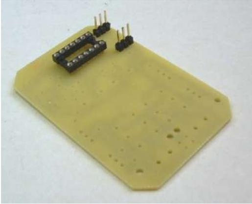
**PICTURE 1: IC socket & headers fitted**
